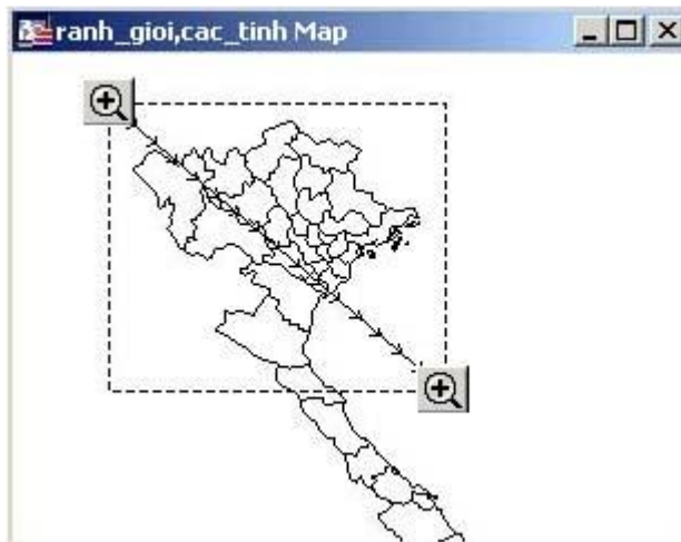
Hình VIII.1. Điều chỉnh vùng muốn hiển thị, hướng mũi tên trên đường chéo là hướng rê chuột. Vùng nằm trong đường chấm chấm hình chữ nhật sẽ được phóng to hết cửa sổ bản đồ hiện tại.
