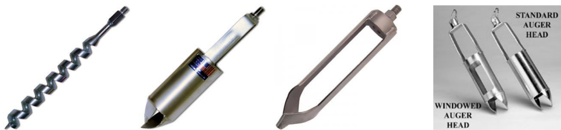
Hình 7.3. Một số dạng khoan lấy mẫu đất
