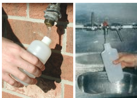
Hình 6.7. Ví dụ về cách lấy mẫu nước từ vòi
