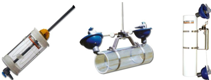
Hình 6.5. Giới thiệu một số dụng cụ lấy mẫu hình trụ mở
