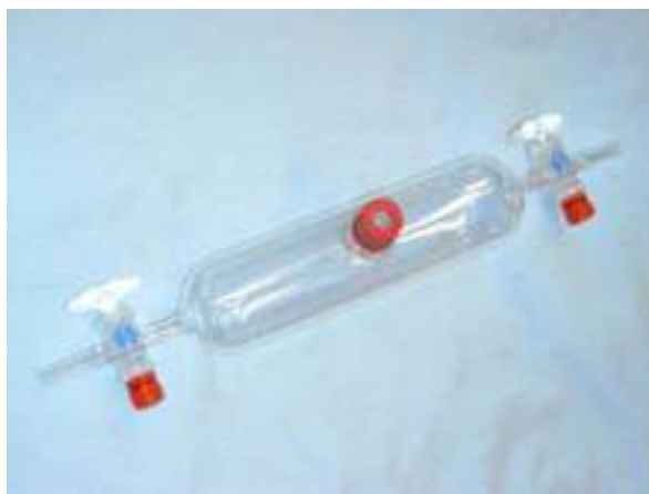
Hình 8.2. Dụng cụ lấy mẫu và chứa mẫu khí theo phương pháp lấy mẫu khô
